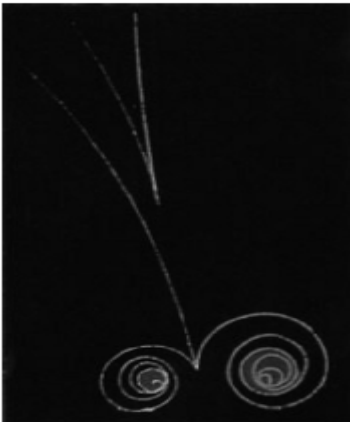
الشكل 18 — 11 عندما ينتج الجسيم هنا ضديد هذا الجسيم ينتج أيضا . هنا تضمحل أشعة جاما إلى زوج من الإلكترون والبوزترون.
